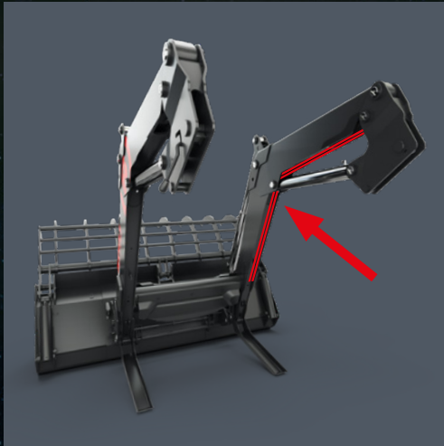
Pokládání trubek pro REAL3 rd
